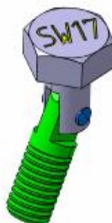
DIN 885 Für wechselnde Winkelfehler
